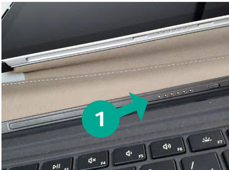
Die Tastatur haftet magnetisch am Bildschirm und kann mit etwas Zugkraft davon getrennt werden. (1) Die Tastatur kann aber erst wieder verwendet werden, wenn sie erneut mit dem Bildschirm verbunden ist.
