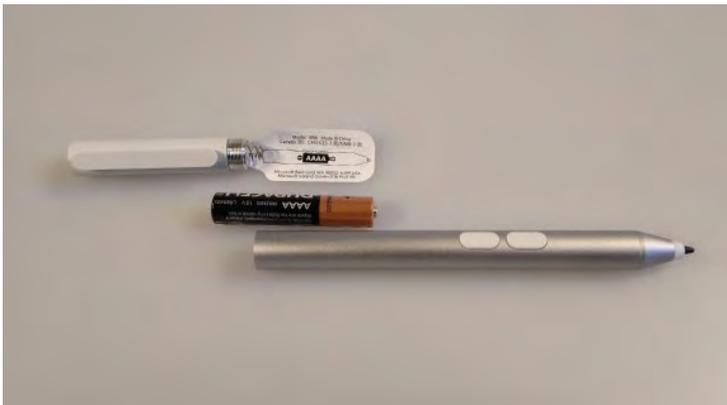
Mit dem mitgelieferten Stift kannst Du wie mit einem normalen Stift auf dem Bildschirm Deines eduBS-Books schreiben. Der Stift funktioniert mit einer AAAA Batterie, die von Zeit zu Zeit gewechselt werden muss. Obere Taste gedrückt halten entspricht Rechtsklick und Auswahl. Untere Taste gedrückt halten dient zum Löschen. Die Rückseite ist funktionslos.
