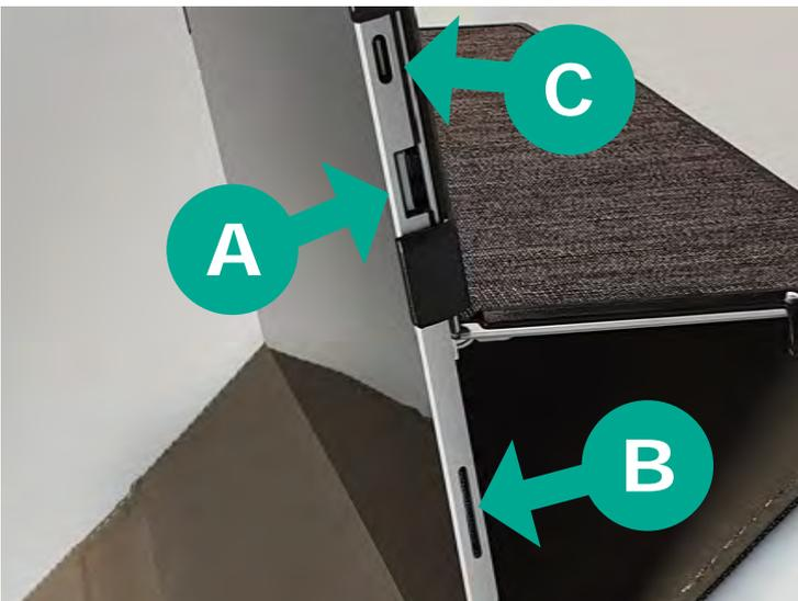
Auf der rechten Geräteseite befinden sich drei Anschlüsse. Hier kannst Du USB-Geräte wie z. B. einen Drucker (A) oder ein Handy (C) anschliessen. Mit einem Adapter kannst Du hier auch einen Beamer anschliessen (C). Zudem kann die Batterie mit dem speziellen Ladeanschluss (B), den du mit dem Starterkit erhalten hast, geladen werden.
