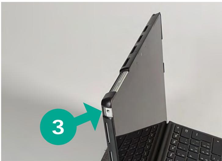
Auf der linken Geräteseite findest Du eine Klinkenbuchse mit kombiniertem Ein-/Ausgang für das Anschliessen von (bspw.) Kopfhörern (3).
